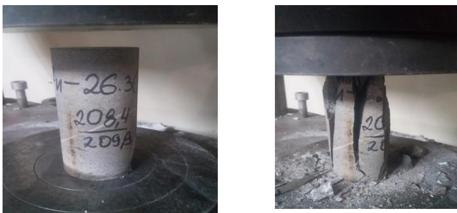
Рисунок 18 – Испытание образцов на сжатие во влажном состоянии
