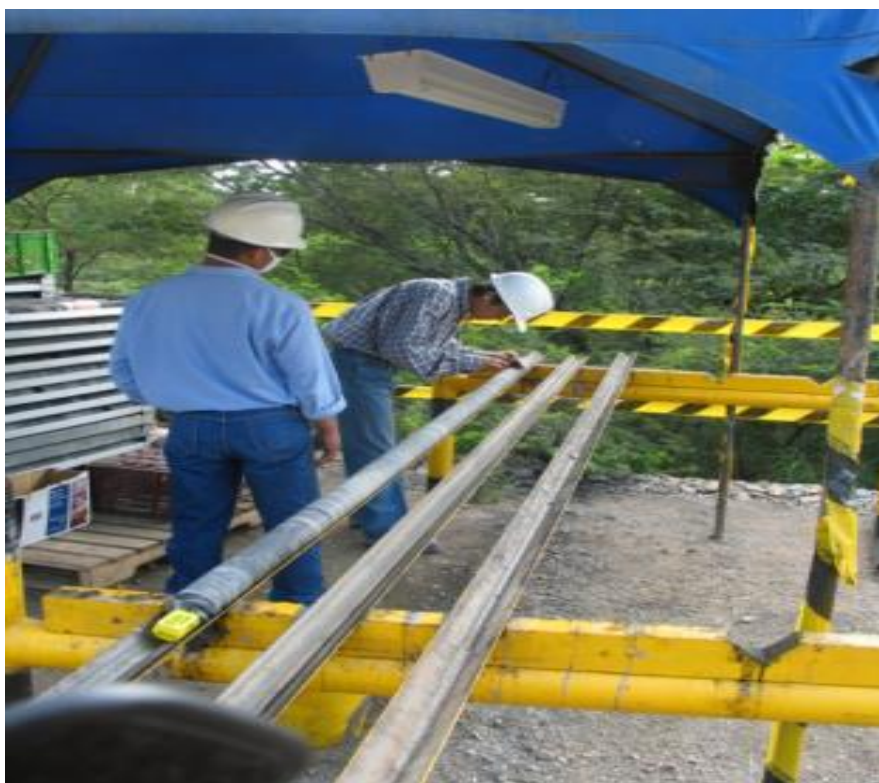
Рисунок 5 – Стол на рабочем месте для геомеханического документирования крнвого материала на месте буровых работ
