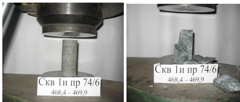
Рисунок 16 – Испытание образцов на сжатие в сухом состоянии
