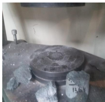
Рисунок 17 – Испытание образцов на сжатие в сухом состоянии
