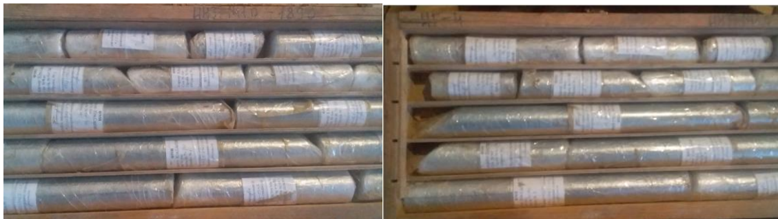
Рисунок 13 – Ориентированный керн в специальных деревянных ящиках
