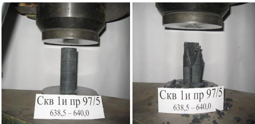
Рисунок 17 – Испытание образцов на сжатие в сухом состоянии
