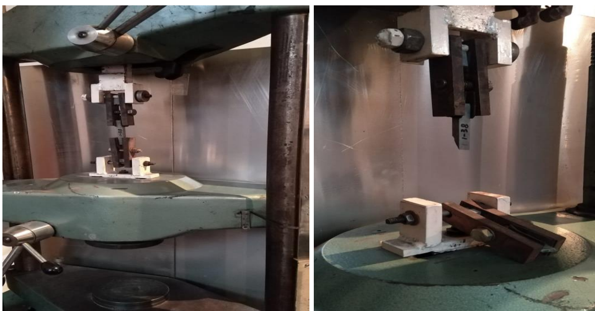
Рисунок 19 – Испытание образцов на растяжение
