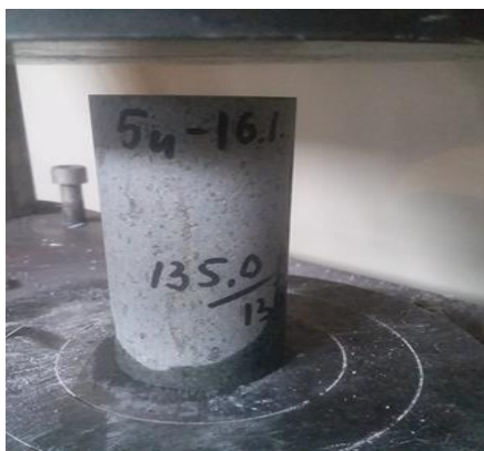
Рисунок 17 – Испытание образцов на сжатие в сухом состоянии
