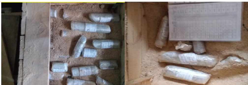
Рисунок 8 – Завернутые образцы в полиэтиленовые пакеты.
